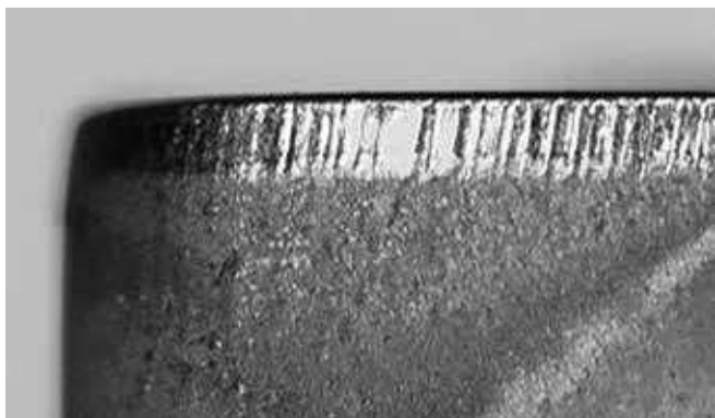
Абразивный износ по задней поверхности, нормальный вид износа после стандартного машинного времени использования.
