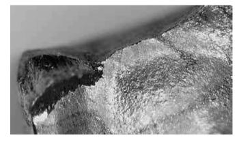
Причина поломки - чрезмерные нагрузки.
