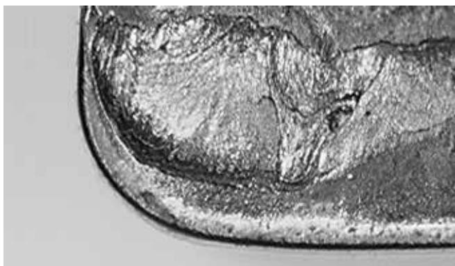
Причина образования лунок - горячая стружка, которая движется по передней поверхности вставки.
